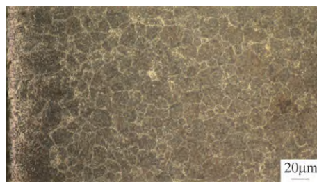
图4 660℃×3h第二次高温回火后空冷 (M+A R 评2级, 硬度27~32HRC)
