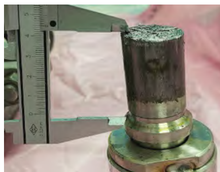
图2 阀杆断裂图片
