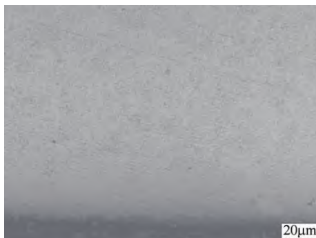
图3 GCr15轴承钢圆锥滚子表层屈氏体检测
