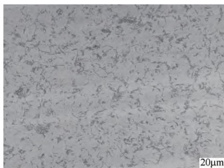
图4 GCr15轴承钢圆锥滚子心部屈氏体检测
