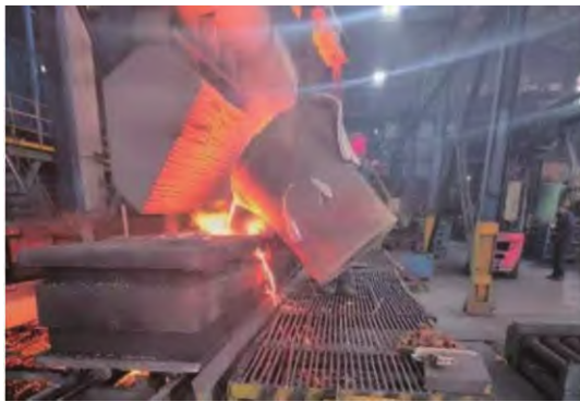
图4 节能铁液浇包生产应用现场
