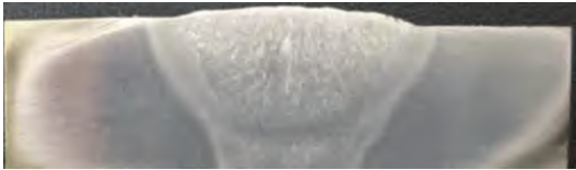
图3 焊接接头金相试样
