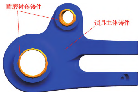
图1 锁具部件装配示意
