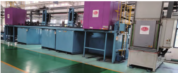
图1 底装料多用炉
