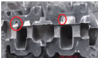
图3 冒口径缩松深入法兰
