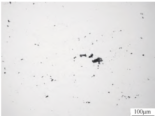
c) 闸板纵向剖面试样抛光态疏松形貌
