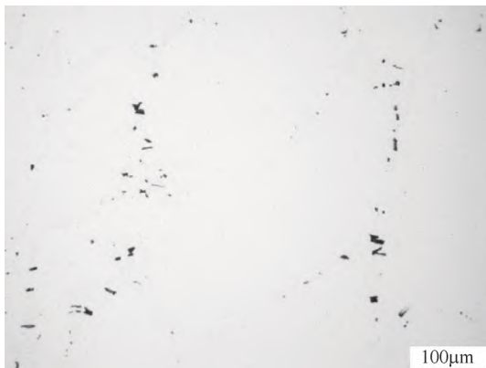
b) 闸板横向剖面试样抛光态疏松形貌
