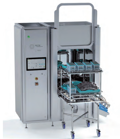
ARUNA 的清洁设备极大地缩短了机械零件和压片工具的清洗时间，同时也节省了空间
