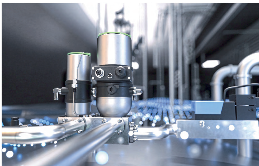
可以通过点对点连接将多达 8 个的 IO-Link 设备 (例如 Bürkert 宝帝的这些控制阀门) 连接到一个主站
