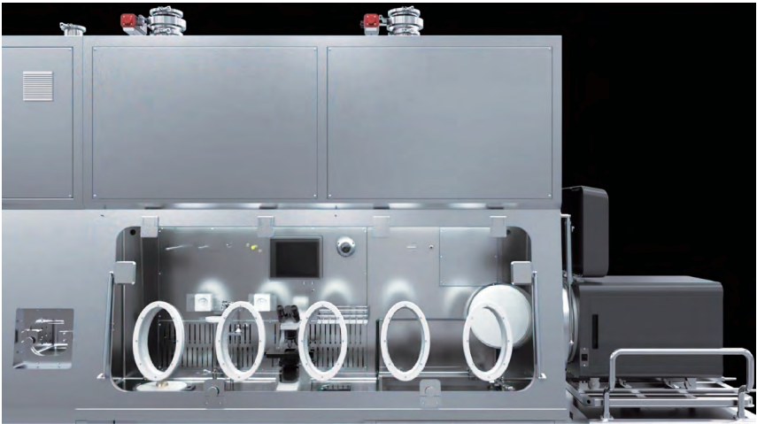
图 1 隔离器和培养箱对接后同时在线灭菌循环被视为生物领域灭菌的黄金标准
