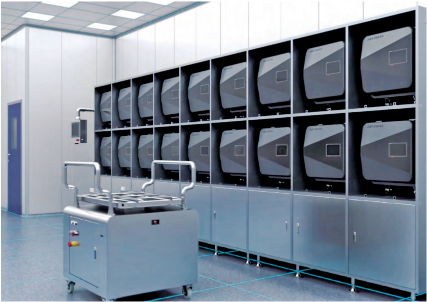
图 2 培养箱转运小车和蜂巢培养系统共同使用,可满足大规模、不同批次细胞培养要求
