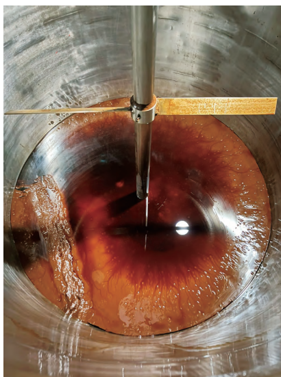
图1 夏桑菊颗粒浸膏水提醇沉时产生的沉渣
