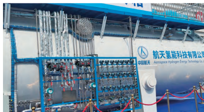
图3 航天氢能国产 5 t/d 氢液化系统冷箱
