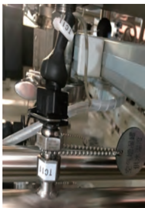
图1 JUMO VIBRO temp 拧入式热电阻
