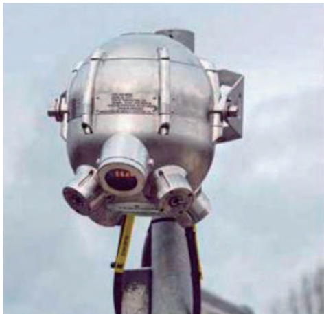
Incus 超声波气体泄漏检测系统非常适合监测通风良好的室外区域
