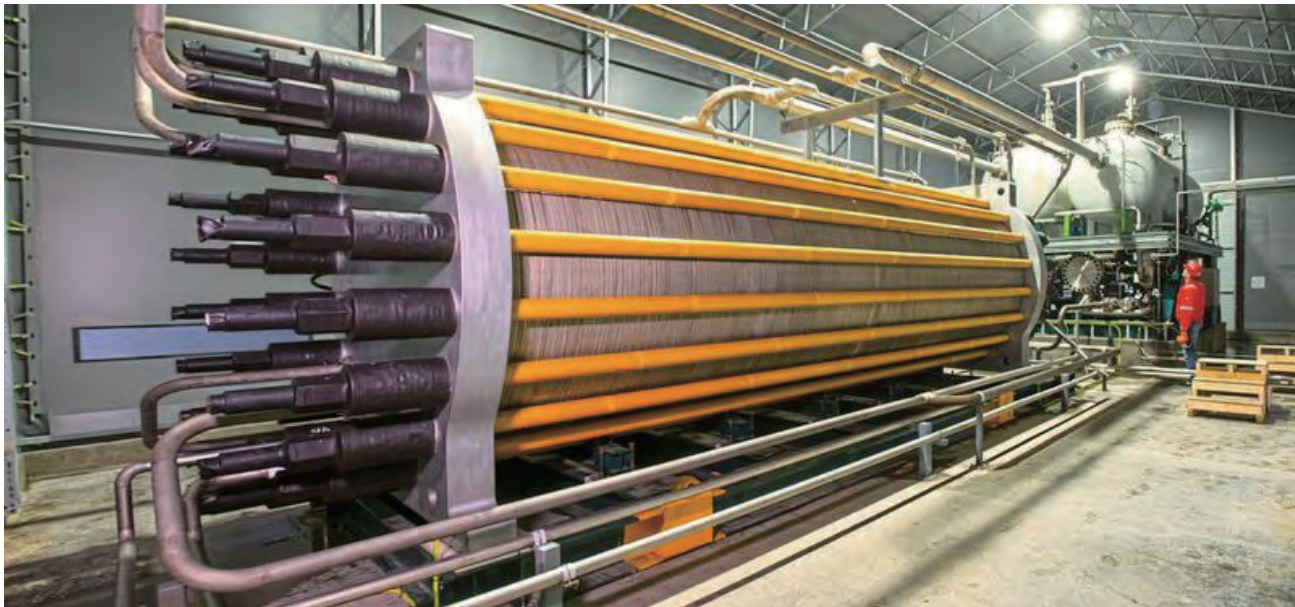
HydrogenPro 公司世界知名电解槽产品提供商，其在挪威 Herøya 测试基地拥有目前世界上最大的单堆高压碱性电解槽
