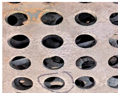
图 2 蒸煮处理后格栅的腐蚀情况
