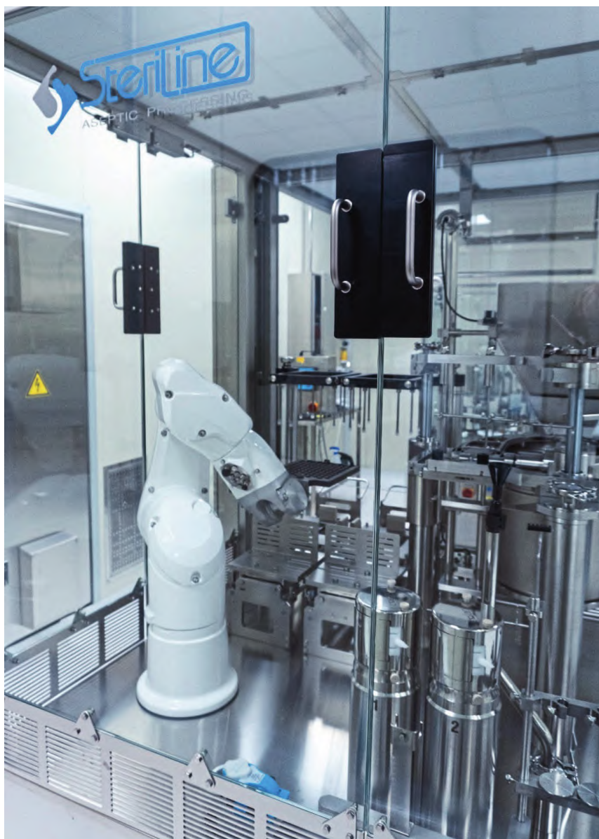
机器人装巢机（RNFM2）的细节
