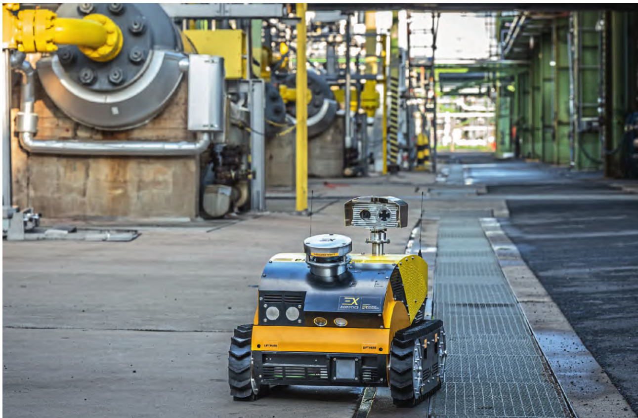
ExRobotics 公司的这款 EXr-2 滚动履带式机器人还可用于防爆区域
