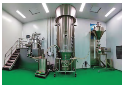
图4 湿法制粒流水线
