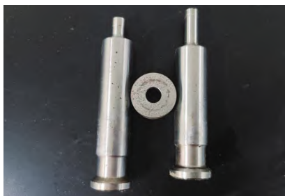
图3 左：上冲杆，中：中模，右：下冲杆 会有一些粉末或碎片残留在模具周围，余料回收除粉区的作用是清除这些残余物，保持压片区域的清洁，并将回收的余料重新利用。这一过程通常通过真空吸尘或其他除粉设备来完成；
