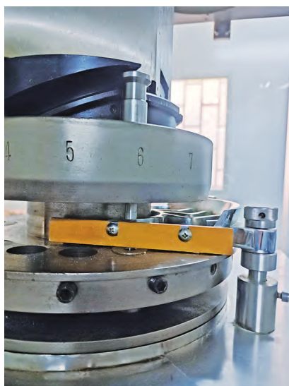
图5 冲模以及月形栅加料器中刮粉板工作状态
