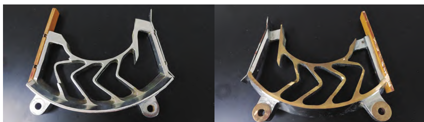
图2 月形栅加料器（左正面右反面），左右附有刮料板
