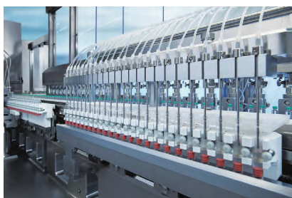
MLD 5120 分步灌装减少生产时泡沫的产生
