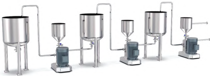
图1 连续制造示意图
