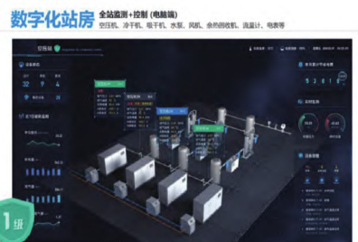
图 10 一级能效空压站房方案系统示例
