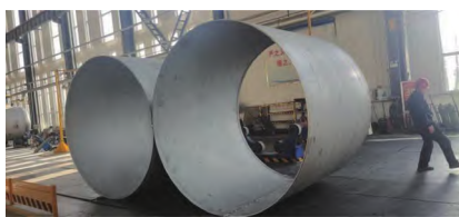
图 3 筒体内部未放置支撑导致圆度超差
