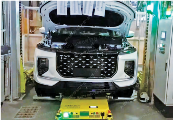
图 6 AGV 到达装配岛状态
