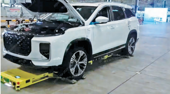
图 5 AGV 将整车搬运至装配岛路程中
