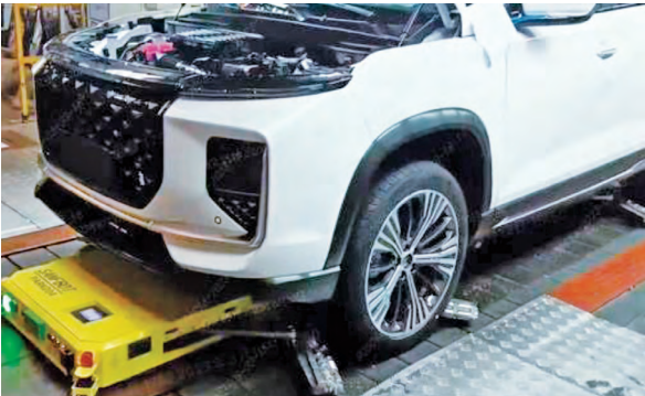
图 4 AGV 轮胎夹紧状态
