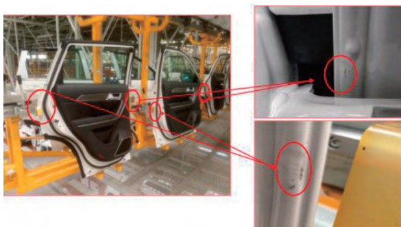
图2 焊缝密封胶开裂
