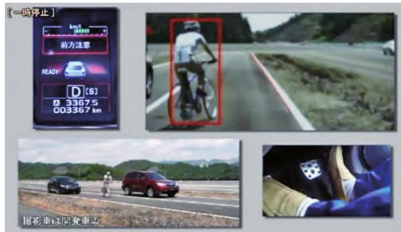
图 1 斯巴鲁第二代 EyeSight 视觉检测
