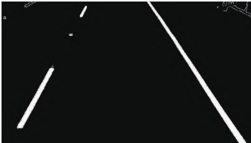
图 6 阈值分割与边缘检测结果叠加
