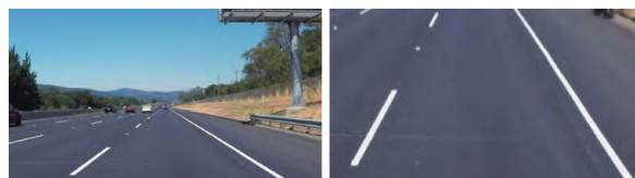
a) 原始图像 b) 去畸变与透视变换
