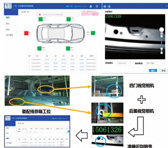
图4 四门两盖钢号识别系统
