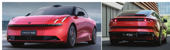
图 1 领克 Z10 前/后灯具贯通式设计
