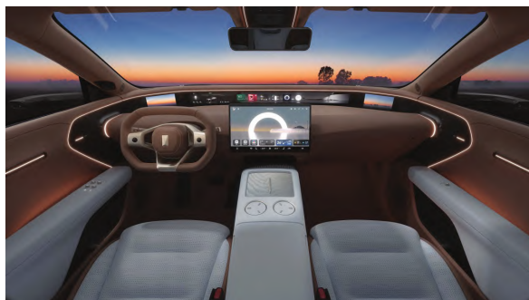
图7 阿维塔 07 仪表板和门板特征貫通式设计
