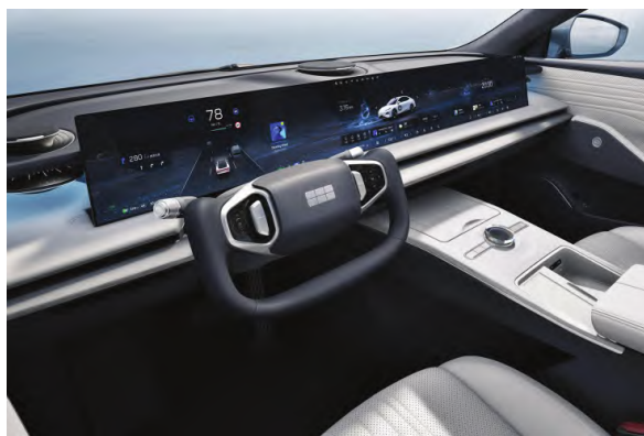
图6 银河 E8 组合仪表和中控屏貫通式设计
