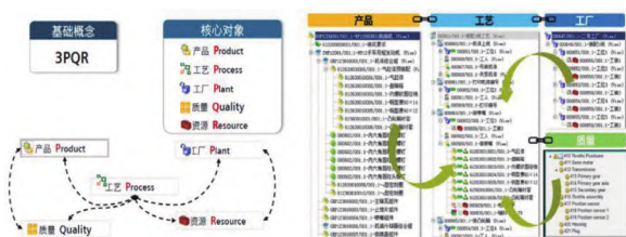
图6 工艺协同设计 PLM 系统示意
