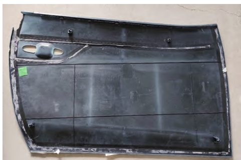
图5 塑料外板破坏实验后状态
