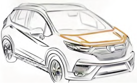
c) 塑料发动机罩粘接
