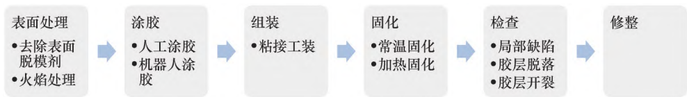
图1 粘接技术主要工艺流程
