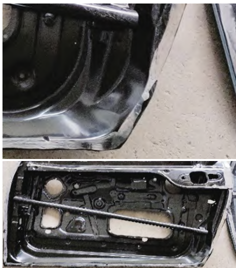
图4 内板钣金骨架破坏实验后状态
