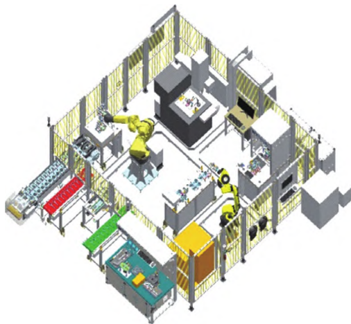
图1 连杆柔性测量岛结构布局
