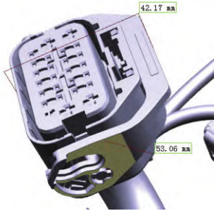
图6 线束接插头尺寸测量示意图
