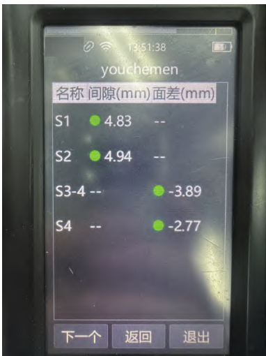
图7 手持式测量枪检测数据示意
