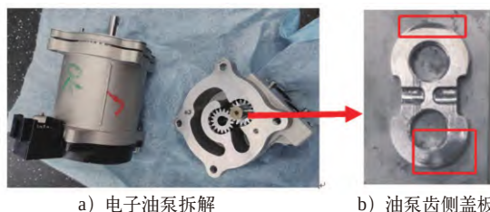
图6 故障电子油泵单体件拆解
