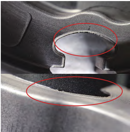
图6 U形槽槽口有较多毛刺
