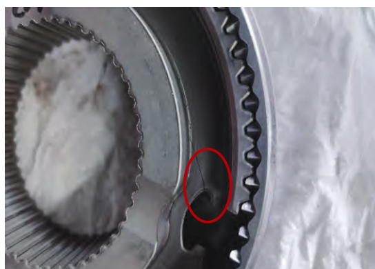
图1 齿毂U形槽处开裂
