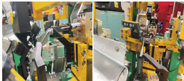
图6 翼子板支架在工装胎上定位状态（旧时序）
