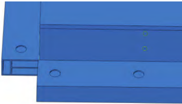
图6 TIE连接模拟焊接
