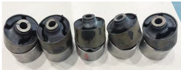
图4 硫化后做脱胶验证试验
