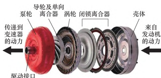
图2 液力变矩器结构
