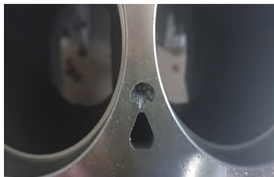
图1 缸体表面气泡缺陷
