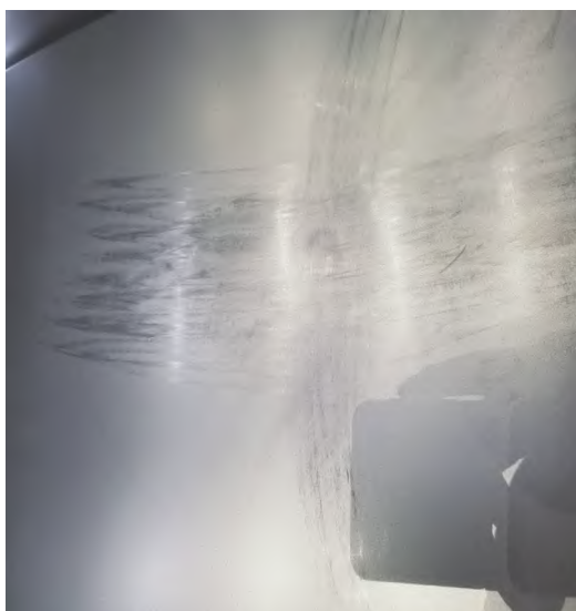
图3 焊接后制件缺陷
