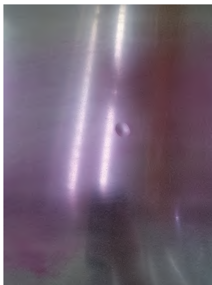
图4 凸模型面受损部位
