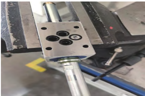
图6 拆卸电磁阀发现卡死
