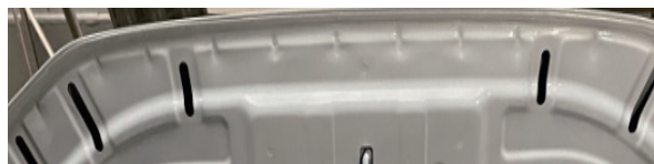
图8 C车型手工验证发盖内板增加加强筋，过涂变形明显降低
