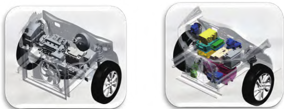
图2 传统车与新能源电动汽车前舱布置示意
