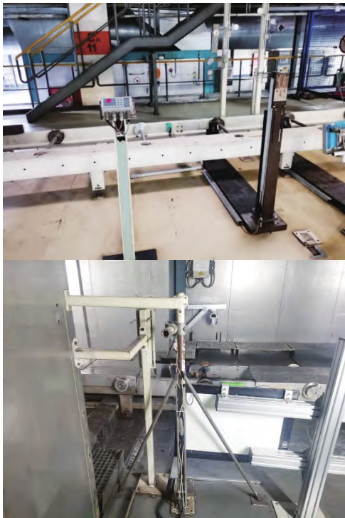
图6 固定扫描装置措施
