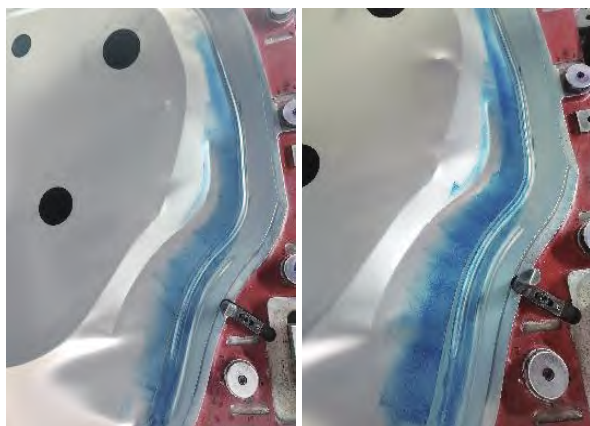
a) 研配前管理面着色差 b) 研配后管理面着色满足要求 图12 研配前后管理面着色对比
