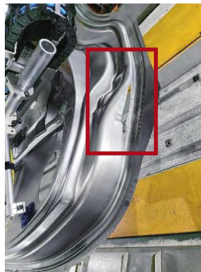
图2 门内板C柱开裂
