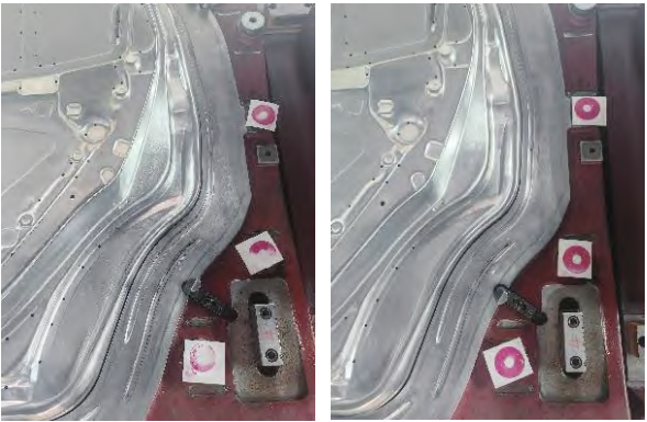
图6 原始平衡块上感压纸着色差 图7 调整后平衡块上感压纸着色
