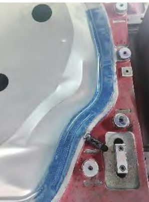
图10 拉伸筋外侧压料面着色过多
