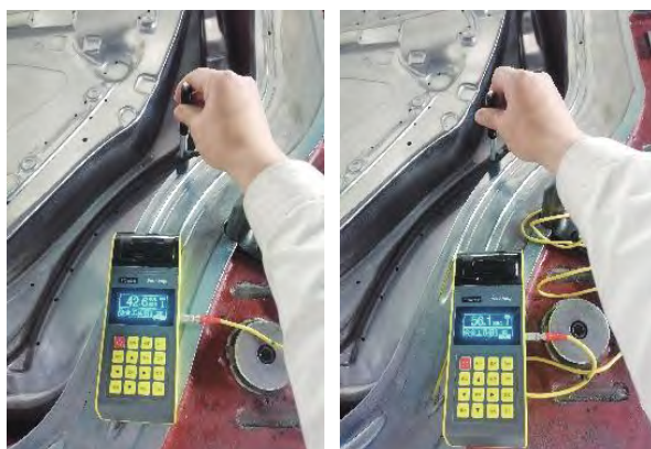
a) 压料圈镀铬前硬度低 b) 压料圈镀铬后硬度符合标准 图13 压料圈镀铬前后对比
