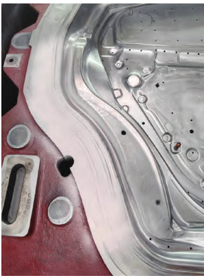
图9 烧焊维修后裂纹消除
