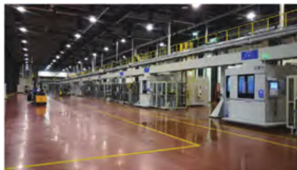
图6 发动机缸盖和变速器阀体柔性加工集成验证平台
