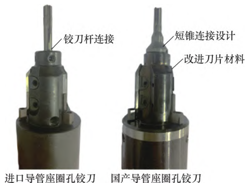
图5 国产导管座圈孔铰刀
